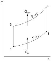
$$COP_{ref} = \frac{h_1 - h_4}{(h_2 - h_1) - (h_3 - h_4)}$$
